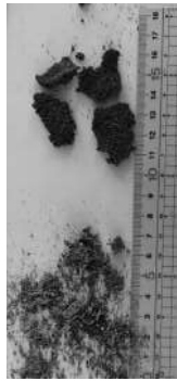
図4 朽木で作成した紙 (左:リグニン未除去 右リグニン除去済) 結果として、リグニンを除去していない場合は粉状であり、除去した方は小さなシート状になった。リグニン除去の手法は妥当性があつたと考えられる。
