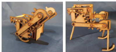
画像2:制作したロボット 跳躍前(左) 跳躍後(右)
